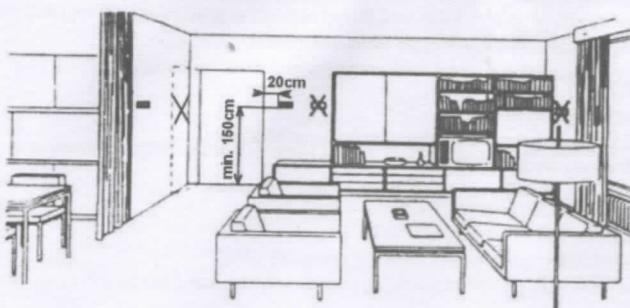
Termostat je určen výlučně k užití v interiéru. Měl by být umístěn na vnitřní stěnu asi 1,5 m nad podlahu, do prostor, kde se budou projevovat změny v celkové teplotě místnosti díky volně cirkulujícímu vzduchu.
